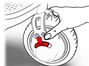
Figur 59 Låsning af frihjul / frigear
